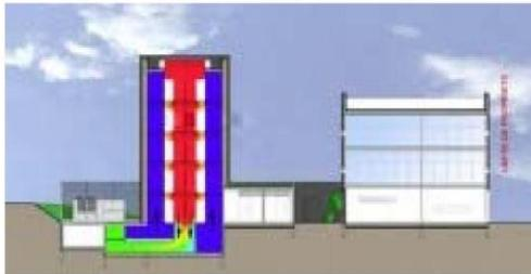
D'une conception originale, Marylin n'emploie aucun fluide caloporteur pour assurer le refroidissement des serveurs : de l'air frais est pulsé au niveau du sous-sol des deux tours du centre de calcul. Il y circule vers le haut des tours, en face avant des baies informatiques. L'air chaud, expulsé en face arrière des tours, sera en partie évacué par le haut des tours et en partie recyclé et rafraîchit par des échangeurs
